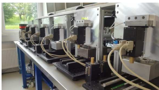
Fig. 4 用于大批量生产的半自动测试站的视图
