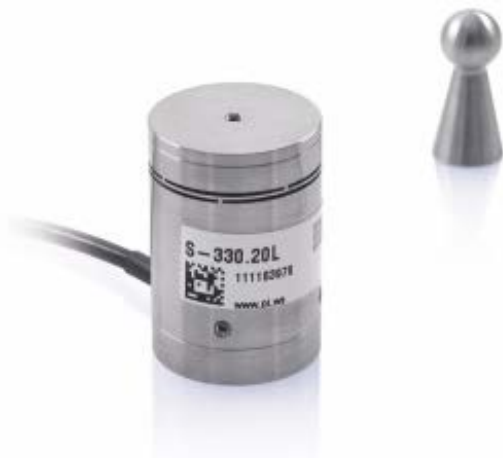
Abb. 1 Hochdynamische, piezogetriebene Kippplattform mit zwei orthogonalen Achsen und optischen Ablenkungswinkeln von bis zu 20 mrad. Bis zu vier Piezoaktoren sind direkt mit der bewegten Plattform gekoppelt. Die Länge der Aktoren bestimmt den Kippwinkelbereich, das System ist daher skalierbar (Bild: PI)
