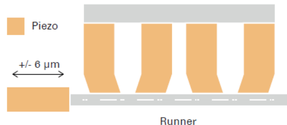
Abb. 2 Hybridkonzept aus Piezoschreitantrieb mit Piezoaktor (Bild: PI)
