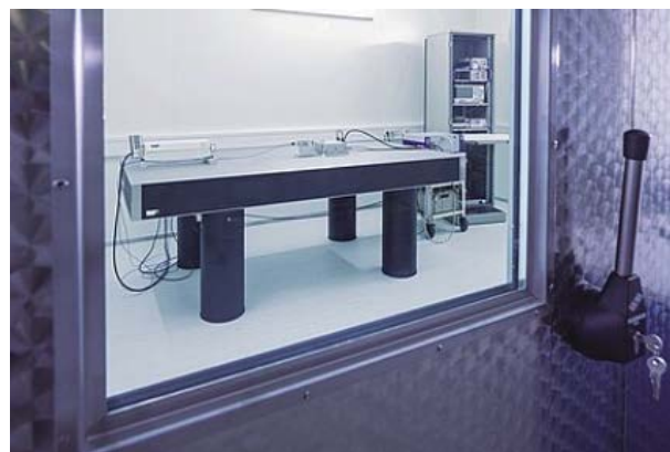
Fig. 1 Blick in ein sechsfach isoliertes Nanometrologielabor. Die Vermessung geschieht vollautomatisch unter kontrollierten Umgebungsbedingungen.
